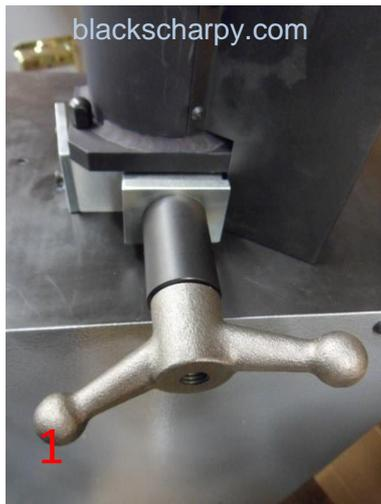
DÉPOSER LA GRANDE POIGNÉE DE SERRAGE. LA GRANDE POIGNÉE DE SERRAGE NE DOIT ÊTRE UTILISÉE QUE POUR DES ÉPROUVETTES DE 10 mm.
