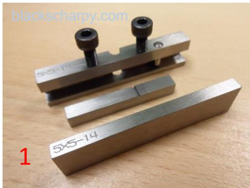
CHOISIR LA CARTOUCHE DE PETITE ÉPROUVETTE APPROPRIÉE POUR L'ÉPROUVETTE SUBISSANT L'OPÉRATION.
