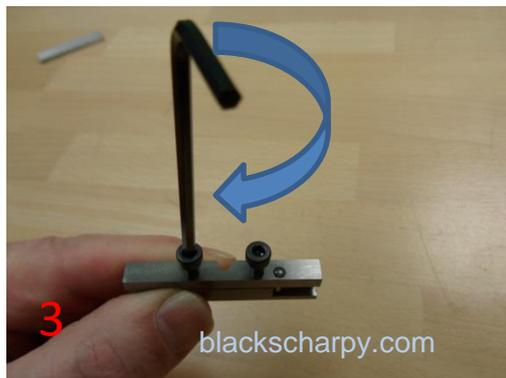
SERRER LÉGÈREMENT LES VIS, TOUT EN POUSSANT L'ÉPROUVETTE CONTRE LA BROCHE ET LA FACE ARRIÈRE DE LA CARTOUCHE.
