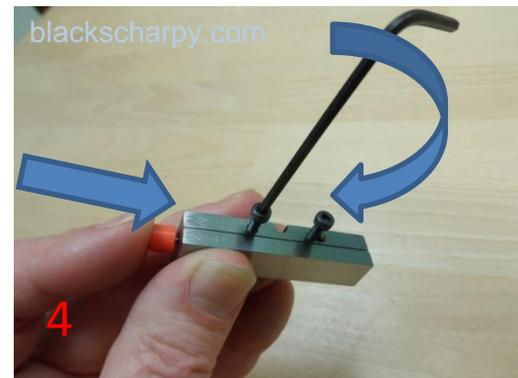
POUR LES ÉPROUVETTES INFÉRIEURES À 3 mm, UTILISER LE POUSSOIR ET LA PLAQUE ARRIÈRE POUR FACILITER LA TÂCHE PENDANT LE SERRAGE LÉGER DES VIS.
