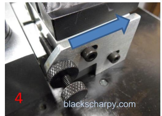
DESSERRER LES 2 VIS ET FAIRE GLISSER LA PLAQUE LATÉRALE AXIALE POUR LA REMETTRE À SA PLACE. LA VIS AXIALE SE POSITIONNE ALORS SUR LA FACE EXTRÊME DE LA CARTOUCHE DE PETITE ÉPROUVETTE. SERRER LES 2 VIS.
