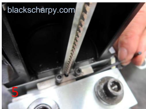
DESSERRER LA POIGNÉE DE SERRAGE ET UTILISER LA CLÉ HEXAGONALE POUR POUSSER LA PLAQUE ARRIÈRE ET LA LIBÉRER. RETIRER LA CARTOUCHE ET LIBÉRER L'ÉPROUVETTE. NETTOYER TOUTES LES PARTIES ET VOUS ÊTES PRÊT À PROCÉDER AVEC UNE AUTRE PETITE ÉPROUVETTE.
