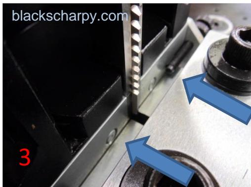
RÉTRACTER LES BROCHES DE SERRAGE, EN FAISANT TOURNER LA PETITE POIGNÉE DE SERRAGE.
