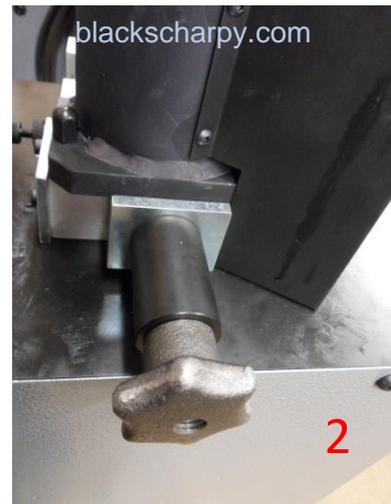
INSTALLER LA PETITE POIGNÉE DE SERRAGE. LA PETITE POIGNÉE DE SERRAGE EST UTILISÉE UNIQUEMENT POUR LES PETITES ÉPROUVETTES.
