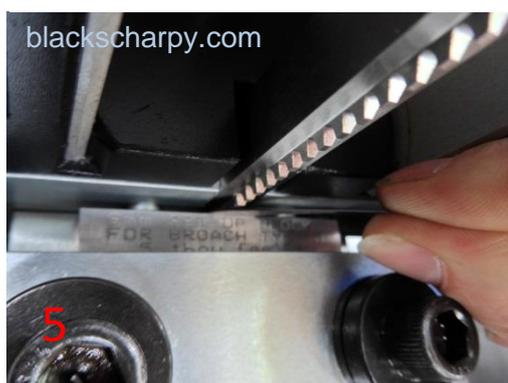
RÉGLER LA PROFONDEUR DE LA BROCHE ET LA POSITION AXIALE EN RESPECTANT LA DESCRIPTION DANS LE MODE D'EMPLOI DE LA MACHINE CNB.
