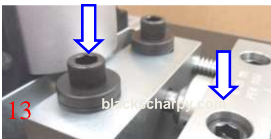
Draai de schroeven van de klem vast
