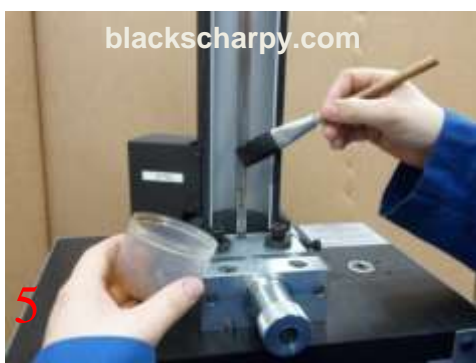
Breng snijolie aan op de brootstanden met de daarvoor meegeleverde borstel.
