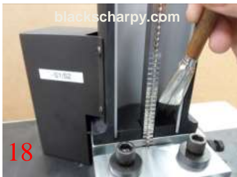
Reinig de ruimte rondom de werkstukkleem en binnen de brootskap grondig met de meegeleverde borstel. De machine is nu klaar om de volgende groef te brootsen
