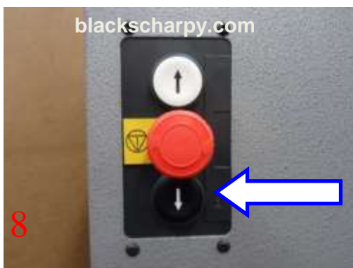
CNB31– Druk neerwaarts om het werkstuk te brootsen
