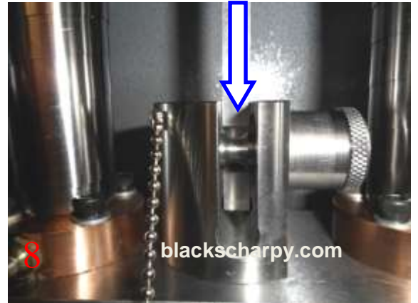
Steek de broots door de bovenplaat naar de brootspen
