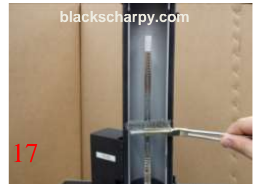
Reinig de brootstanden met de meegeleverde staalborstel, en controleer of alle spanen uit de ruimtes tussen de tanden zijn verwijderd
