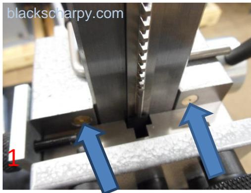
KLEMMBOLZEN DURCH DREHEN DER KLEMMGRIFFE ZURÜCKZIEHEN.
