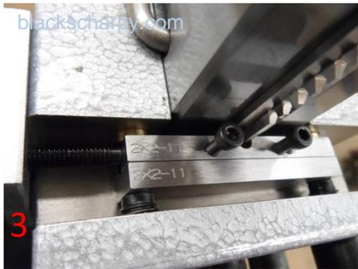
SICHERSTELLEN, DASS DIE KASSETTE GEGEN DEN AXIALEN ANSCHLAG NACH OBEN GEDRÜCKT WIRD.
