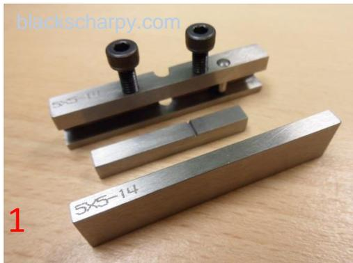
KORREKTE KASSETTE FÜR KLEINE PROBE FÜR DIE PROBE WÄHLEN, DIE AUFGEDORNT WIRD.
