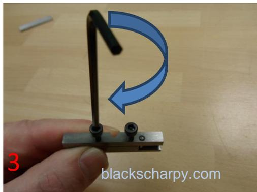
SCHRAUBEN LEICHT ANZIEHEN WÄHREND DIE PROBE GEGEN DEN BOLZEN UND DIE RÜCKSEITE DER KASSETTE GEDRÜCKT WIRD.
