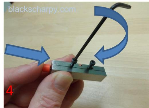
FÜR PROBEN VON WENIGER ALS 3 MM SCHIEBER UND RÜCKWAND ALS UNTERSTÜTZUNG VERWENDEN, WÄHREND DIE SCHRAUBEN LEICHT ANGEZOGEN WERDEN.
