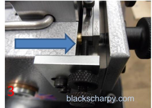
DIE BEIDEN SCHRAUBEN LÖSEN UND DIE AXIALE SEITENPLATTE SO SCHIEBEN, DASS DIE AXIALE SCHRAUBE AUF DER STIRNSEITE DER KLEINEN PROBENKASSETTE ANGEORDNET IST. DIE BEIDEN SCHRAUBEN FESTZIEHEN.
